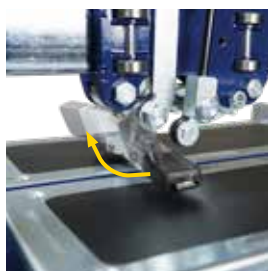
Tête de rupture en aluminium avec aimant
