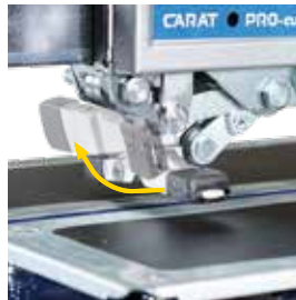
Tête de rupture en aluminium avec aimant
